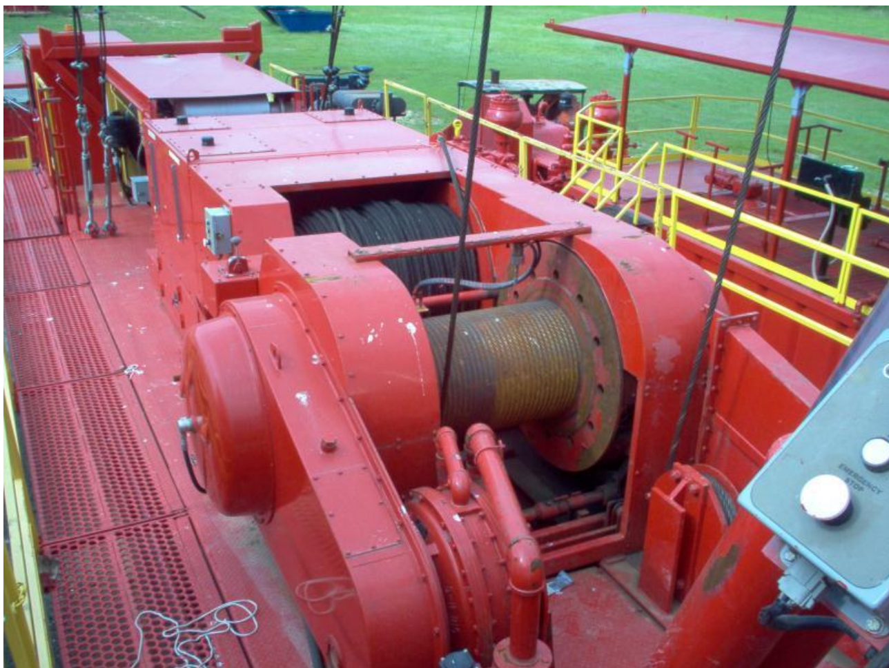
1.2 Сурет – ZJ-40 бұрғылау қондырғысы шығырының жалпы көрінісі
